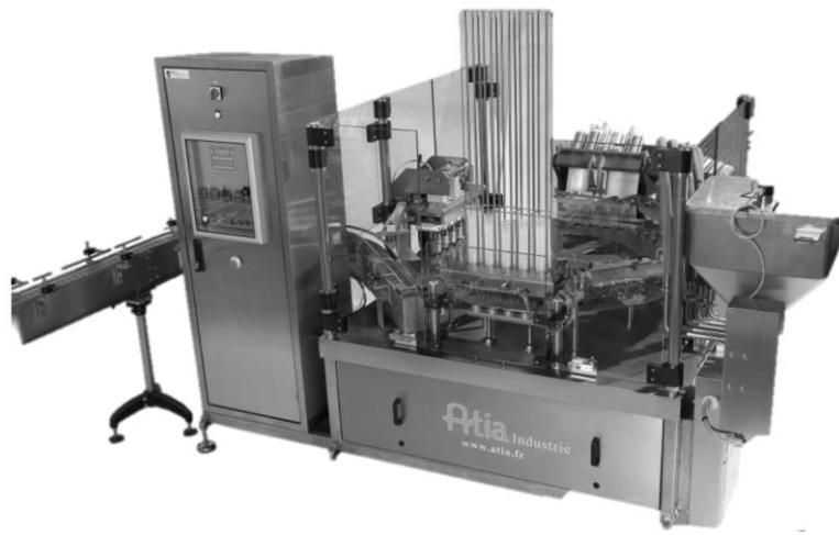
Cette machine à plateaux circulaire allant de 3 à 5 pistes permet de dépiler, remplir et sceller des pots de 68 à 115 mm de diamètre avec une hauteur maximum de 100 mm.
