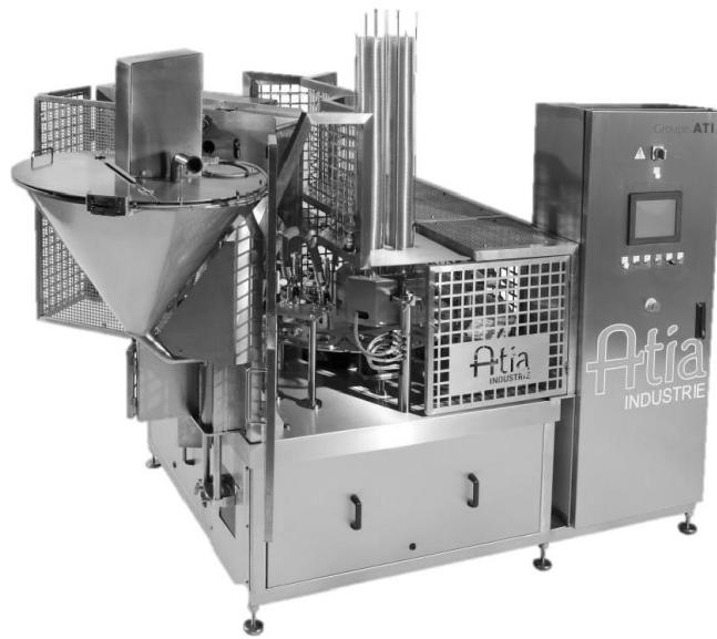
Cette machine à plateaux circulaires allant de 2 à 3 pistes permet de dépiler, remplir et sceller des pots de 68 à 115 mm de diamètre avec une hauteur maximum de 100 mm.
